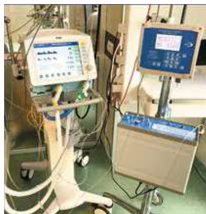
Аппарат для ингаляции оксида азота «Тианокс», синтез оксида азота из атмосферного воздуха
