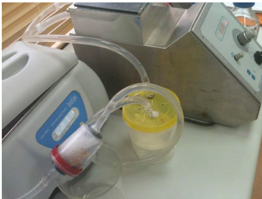
Рисунок 15 - Децеллюляризация аортального гомографта в биореакторе
