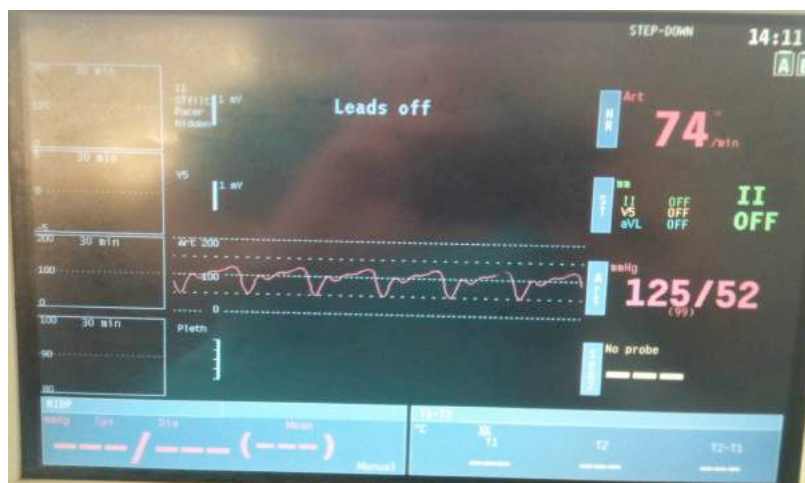
Рисунок 13 — Кривая давления, регистрируемая на портативном мониторе при создании пульсирующего потока жидкости в биореакторе
