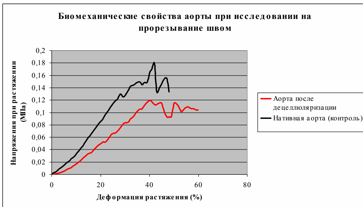
Рисунок 26 - Зависимость средних величин напряжения растяжения от деформации растяжения при исследовании стенки восходящей аорты на устойчивость к прорезыванию швом
