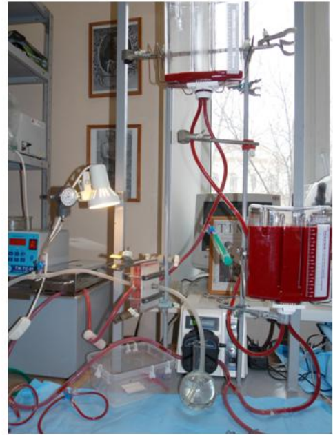
Рисунок 1 - Принципиальная схема и внешний вид экспериментального стенда для исследования функциональных характеристик хроматомембранного оксигенатора
