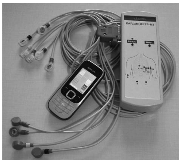
Рис. 3. Устройство съема информации, комплект электродов и проводов для съема ЭКГ в 12 общепринятых отведениях и мобильный телефон, дополненный специальной программой, позволяющей осуществить синхронную 24 секундную запись кардиосигнала и его передачу через Bluetooth на сервер с последующим отображением шкал, характеризующих ритм сердца и форму предсердно-желудочкового комплекса, в режиме «норма, отклонение от нормы, патология»
