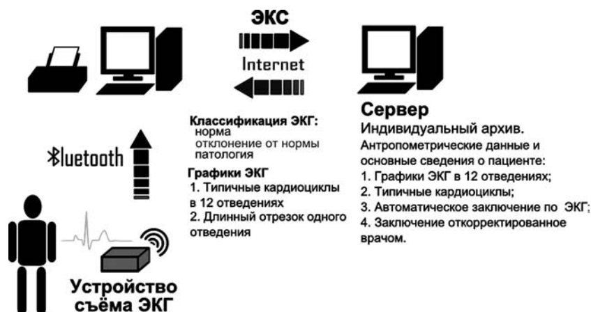
Рис. 2. Схема передачи электрокардиограммы через Bluetooth персонального компьютера на сервер с помощью устройства съема ЭКГ и получения предварительных результатов автоматического анализа в режиме «норма, отклонение от нормы, патология» и/или графика ЭКГ в 12 общепринятых отведениях. ЭКС — электрокардиосигнал
