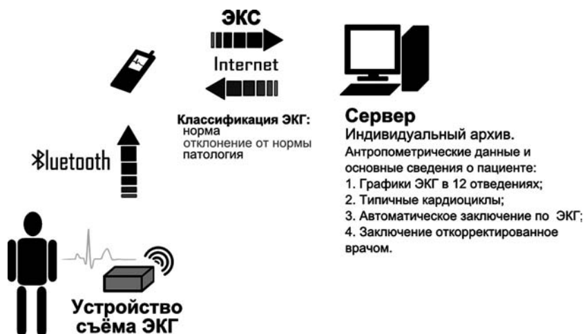
Рис. 1. Схема передачи электрокардиограммы через Bluetooth мобильного телефона на сервер с помощью устройства съема ЭКГ и получения предварительных результатов автоматического анализа в режиме «норма, отклонение от нормы, патология». ЭКС — электрокардиосигнал
