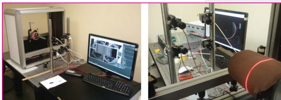
Рис. 12. Экспериментальный образец бесконтактного лазерного оптического окклюзионного плетизмографа
