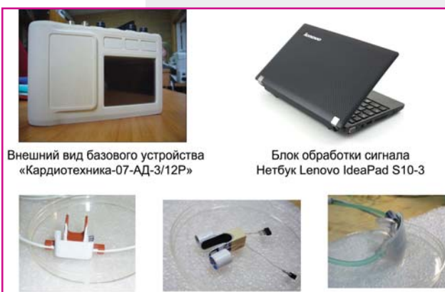
Рис. 11. Варианты датчиков вихревых дыхательных потоков
