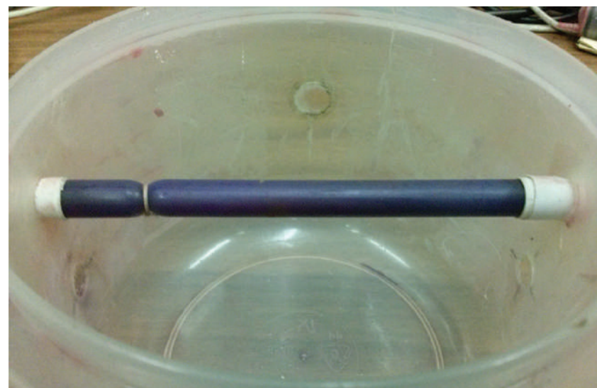
Рисунок 2 Модель сосуда со стенозом, закрепленная в акустической ванночке
