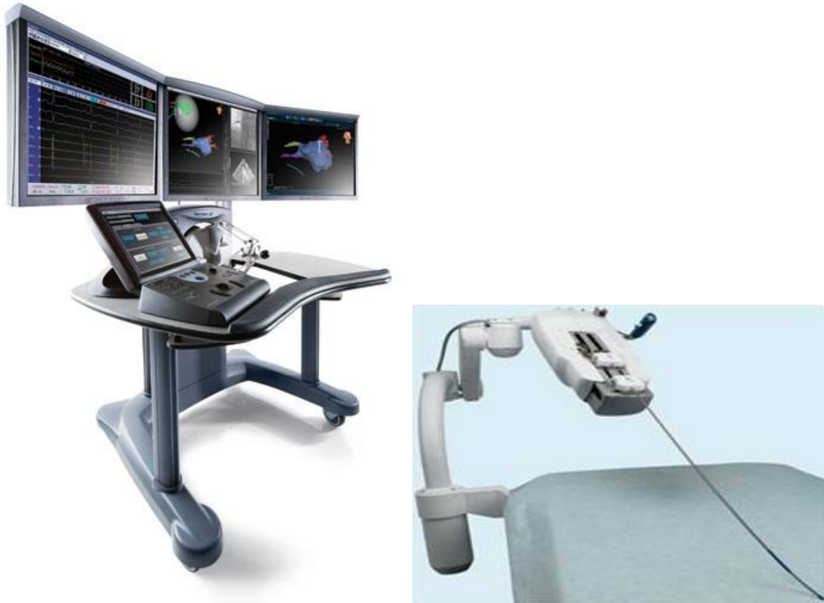
Рисунок 5: Компоненты системы Sensei: Рабочая консоль; Электрод в интродьюсере Artisan; Удаленный роботизированный манипулятор на операционном столе.
