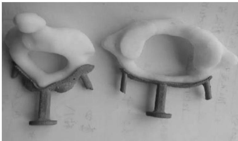
Рисунок 13 – Навигационные матрицы, изготовленные на 3D-принтере из стали по SLM-технологии
