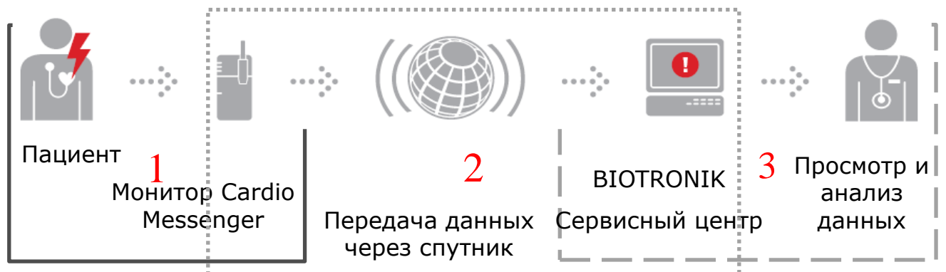
Рисунок 23 – Процесс отправки уведомлений с помощью системы Home Monitoring:
