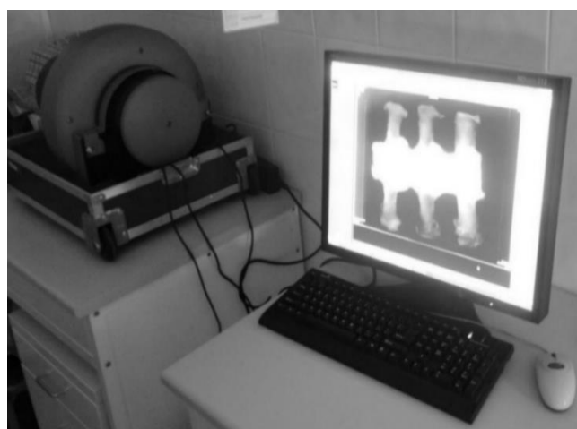
Рисунок 7 – Рентгенологический сканер для преобразования рентгенограмм в цифровое изображение
