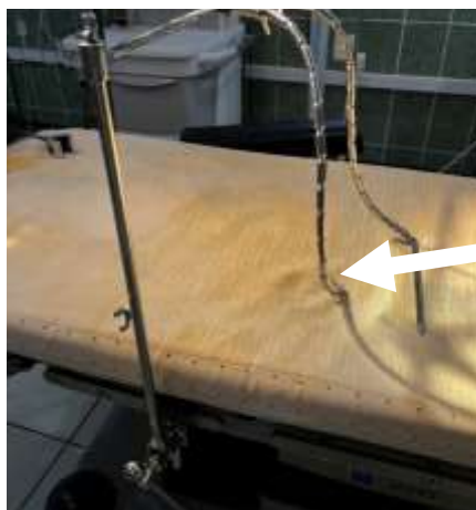
Рисунок 28 - Кронштейн для фиксации устройства к операционному столу (1), с ползуном и рукавами в сборе (2). В одном из рукавов закреплен стержень для прокола (3)
