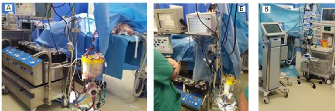
Рисунок 2 – А) Эксперимент с использованием аппарата искусственного кровообращения и оксигенатора; Б) Мониторинг микроэмболов и газового состава крови во время проведения искусственного кровообращения; В) Опытный образец установки плазмохимического синтеза оксида азота
