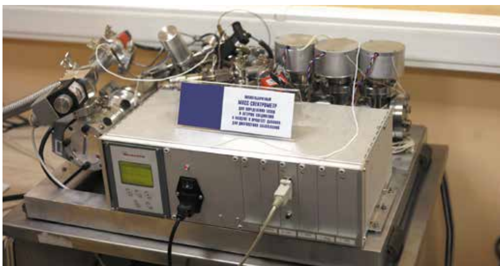
Малогабаритный масс-спектрометр для анализа микросостава выдыхаемого воздуха
