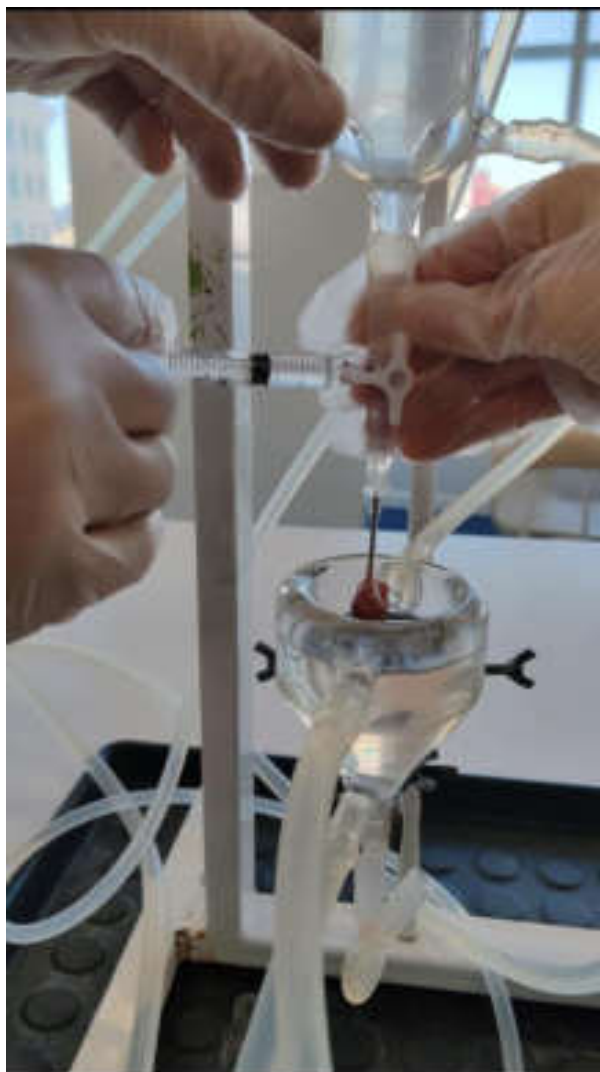
Рисунок 10 – Общий вид. Этап подведения в систему полихлорвиниловых трубок ранее подготовленной взвеси с микросферами
